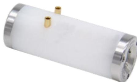
格物光学 设计开发了包括 DKDP、BBO、RTP 和 KTP 系列在内的普克尔斯电池，覆盖从 Hz 到 60 MHz 的频率范围，性能达到国际同等水平。DKDP系列采用横向或纵向电光效应，波长范围从300nm到1300nm，横向所需电压可控制在100伏以内，纵向直径可达15mm；BBO 系列用于 250–1650 nm 范围内，所需电压从 100 伏到数千伏；RTP 系列用于 350–3500 nm 范围内，其频率可达 100 kHz，孔径可达 10 mm；KTP 系列选择热液 KTP 来解决“斑痣变色”现象。
